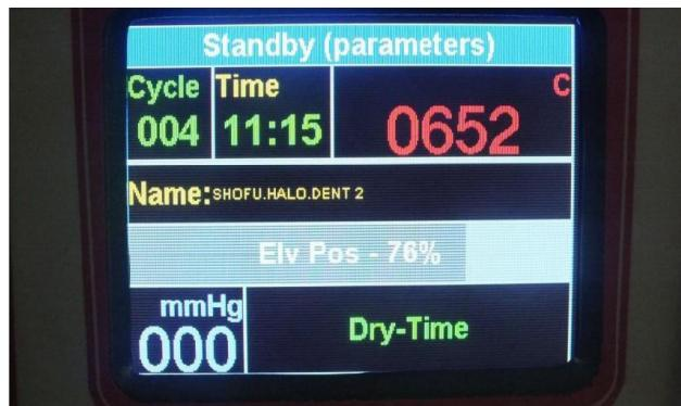
La indicación “vacío” se usa cuando se teclean los parámetros de vacío del ciclo. Durante el ciclo, la pantalla “vacío” muestra el nivel de vacío real en la esquina inferior izquierda. Sección inferior izquierda
